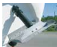
Trimmitasot Bennett. 12V. Sis. trimmilevyt, työsylinterit, hydrauliumpumppu ja käyttökytkimet. Myös jälkiasennukseen.
